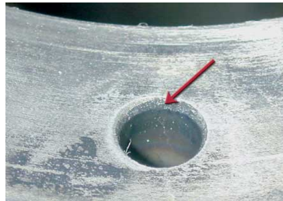
Eingerissen: Werden die Hauptlager nicht mehr mit ausreichend Öl versorgt, kann dies in Extremfällen auch zu einem irreparablen Schaden am Hauptlagersitz (Pfeil im Bild zeigt einen Riss) führen.
