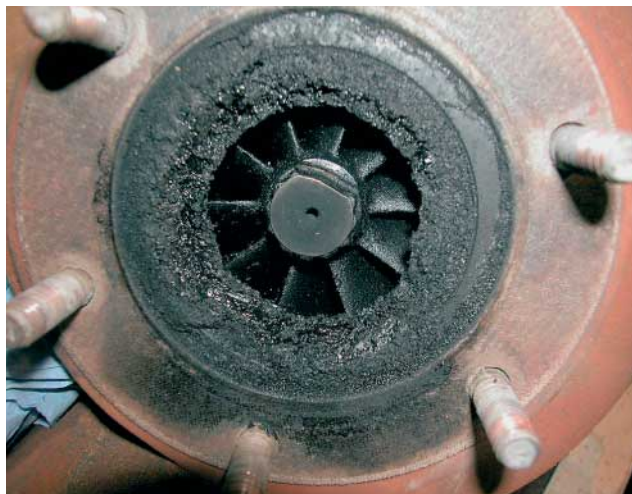
Angefressen: Ist das Öl verschlissen, hinterlässt dies selbst bei Rollenstößeln Fressspuren.
